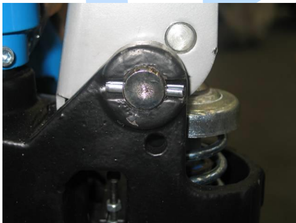
Deichselbolzenposition parallel zum Boden Artikelnummer: GE0000455
