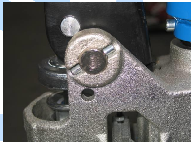
Deichselbolzenposition 45° Winkel zum Boden Artikelnummer: 010102-N105A
