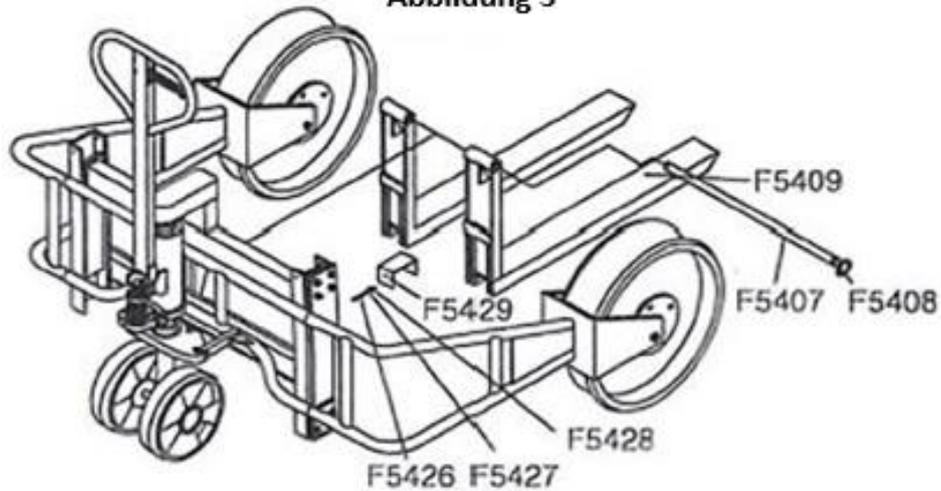
5. Die Montage der Gabeln erfolgt, indem man den Sicherungsring der Führungsstange entfernt. Ziehen Sie die Führungsstange seitlich heraus und ziehen Sie die Gabelzinken auf die Führungsstange auf. Abschließend die Führungsstange wieder in die Ausgangsposition schieben und mit dem Sicherungsring absichern. (Abb. 5)
