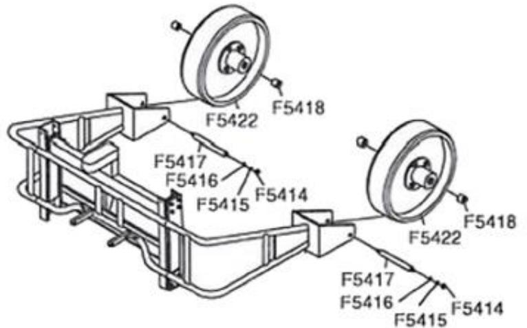
1. Montieren Sie beide Radaufnahmen mit Hilfe der Sechskantschrauben M12, der Unterlegscheibe und Federscheibe. (Abb. 1)
