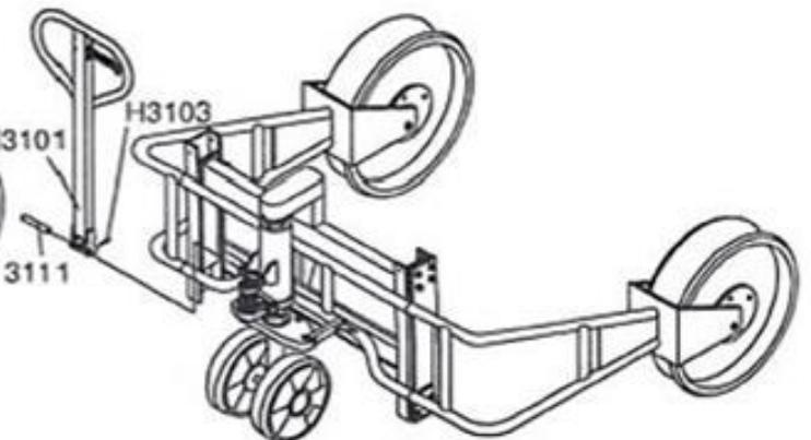
3. Setzen Sie die Pumpeneinheit in den vorgesehenen Halter des Rahmens. Sichern Sie den Kugelkopf der Pumpeneinheit mit einer Innensechskantschraube. Danach wird die Druckplatte mit den zwei beiliegenden Bolzen mit dem Rahmen verbunden und mit Spannstiften gesichert. (Abb. 3)
