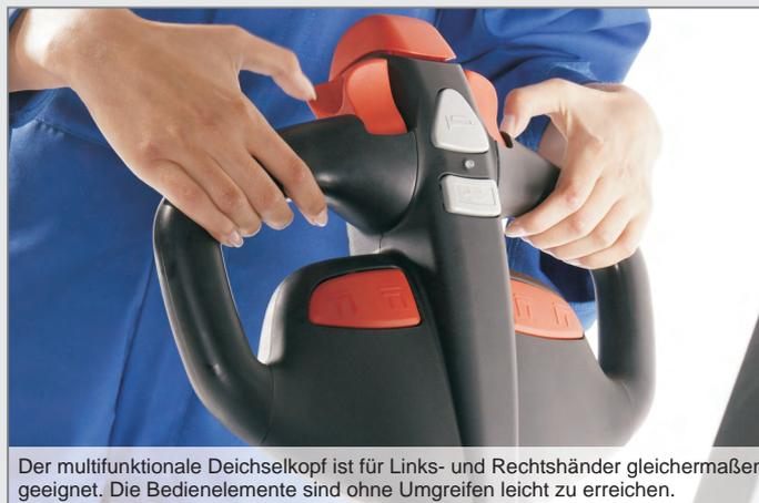
Der multifunktionale Deichselkopf ist für Links- und Rechtshänder gleichermaßen geeignet. Die Bedienelemente sind ohne Umgreifen leicht zu erreichen.
