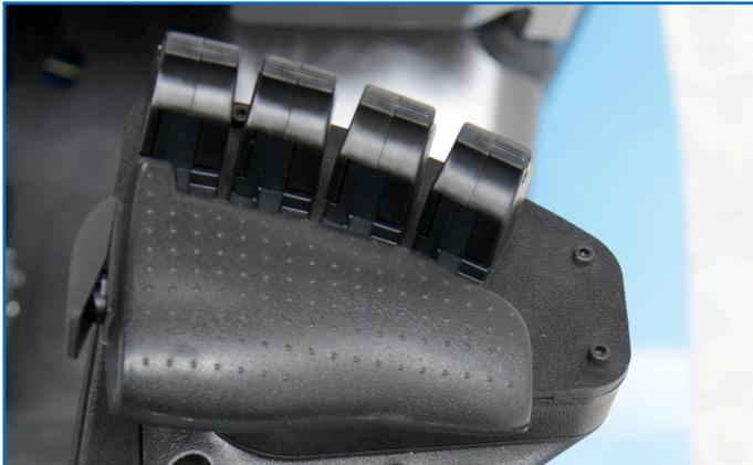
Optional ist eine Fingertippsteuerung erhältlich (2,0 - 3,5t). Diese erhöht den Komfort bei der Arbeit und erleichtert die Steuerung der Hydraulik.
