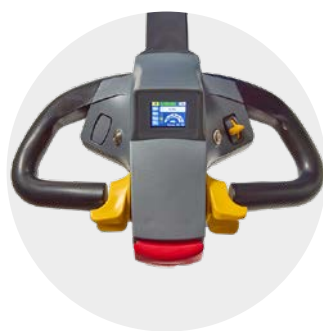
Multifunktionale Deichsel mit einem digitalen Display
