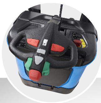
Ergonomische Deichsel mit Kriechgangfunktion für präzise Manövrierbarkeit
