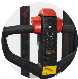
Deichsel mit Batteriestandsanzeige und PIN Code um vor unbefugtem Zugriff zu schützen
