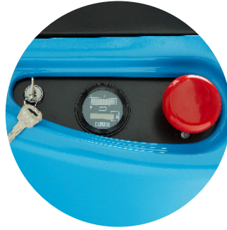
Das übersichtliche Bedienfeld des E-DH1242-TMG mit Anzeige der Betriebsstunden und Ladezustand
