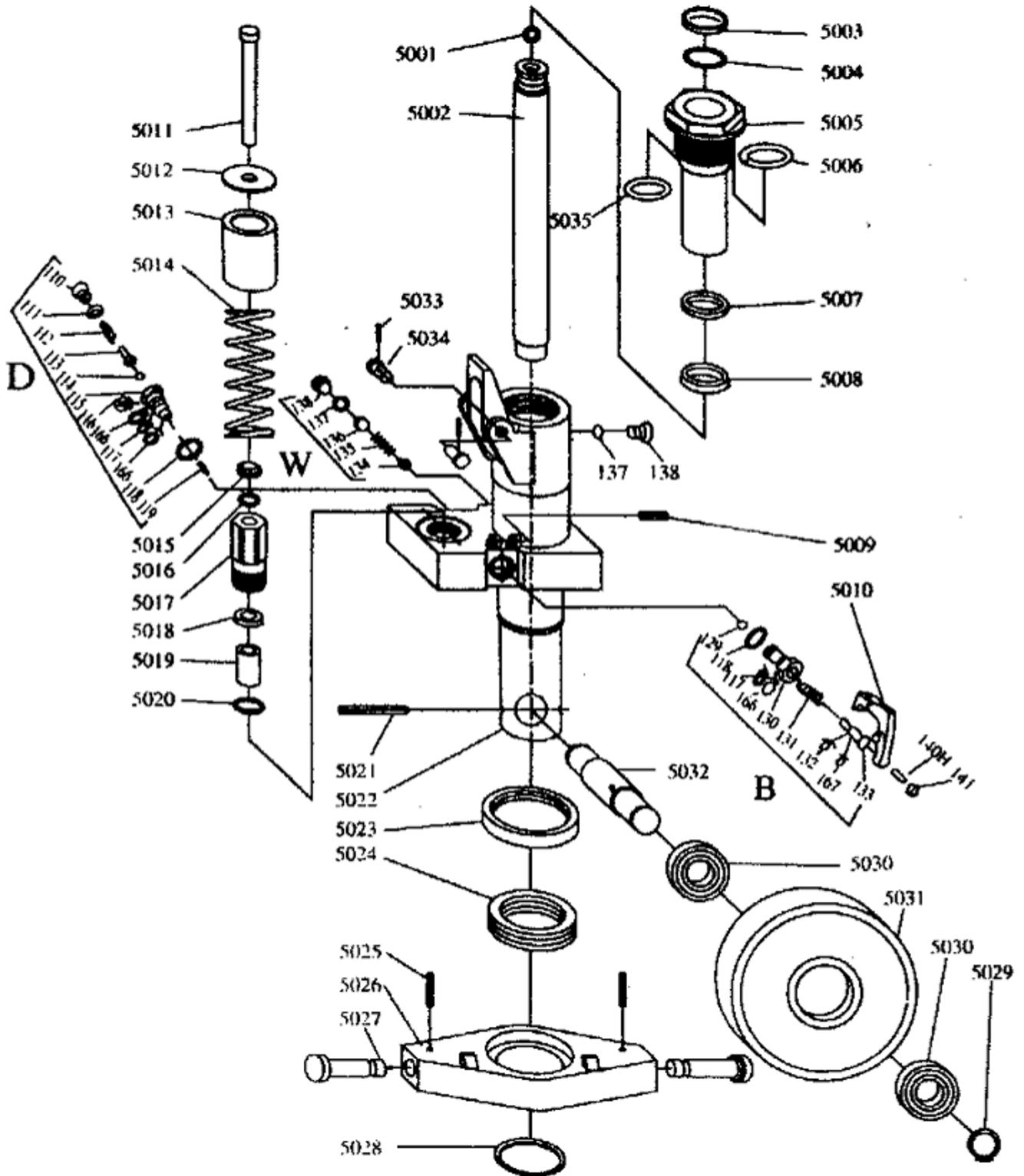
Abbildung 4 Hydraulikeinheit Teil 2
