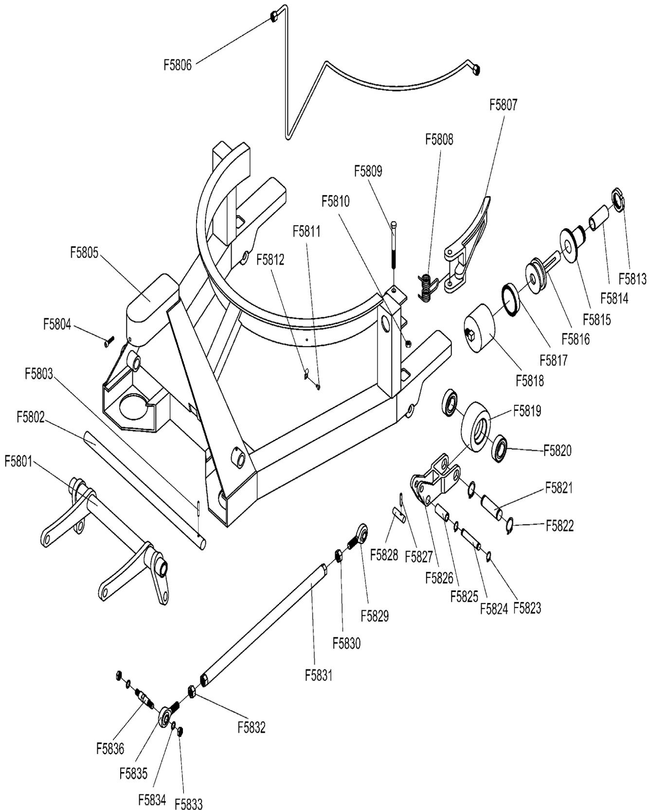
**Abbildung 2 Fasshebevorrichtung und Rahmen**
