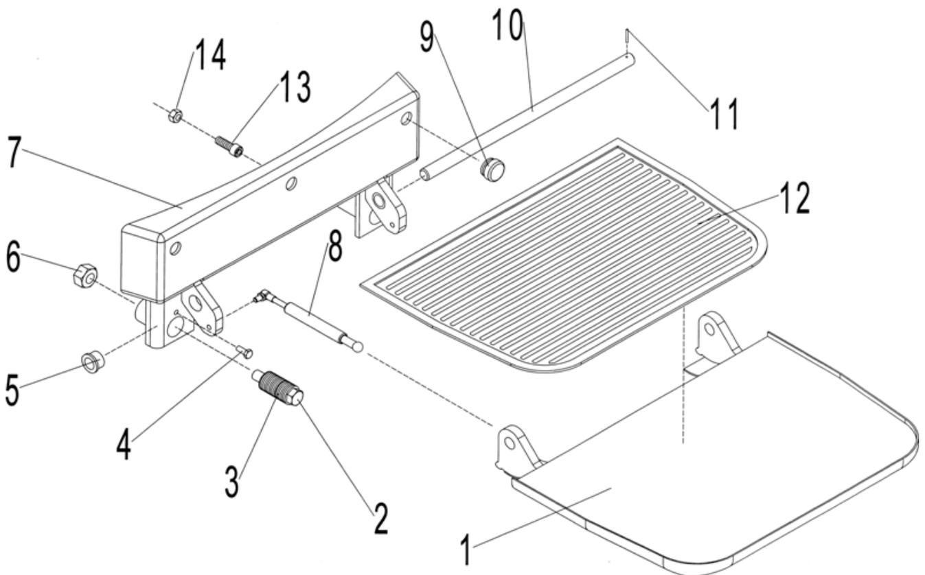
Abbildung 16 Expl. Mitfahrerplatte
