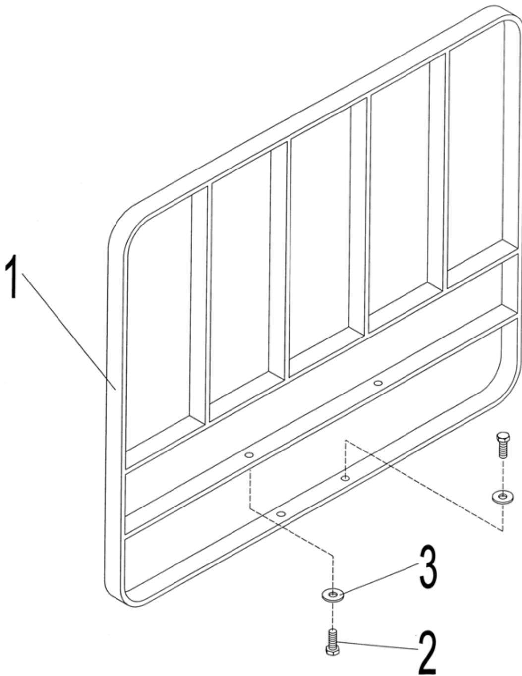
Abbildung 19 Expl. Lastschutzgitter
