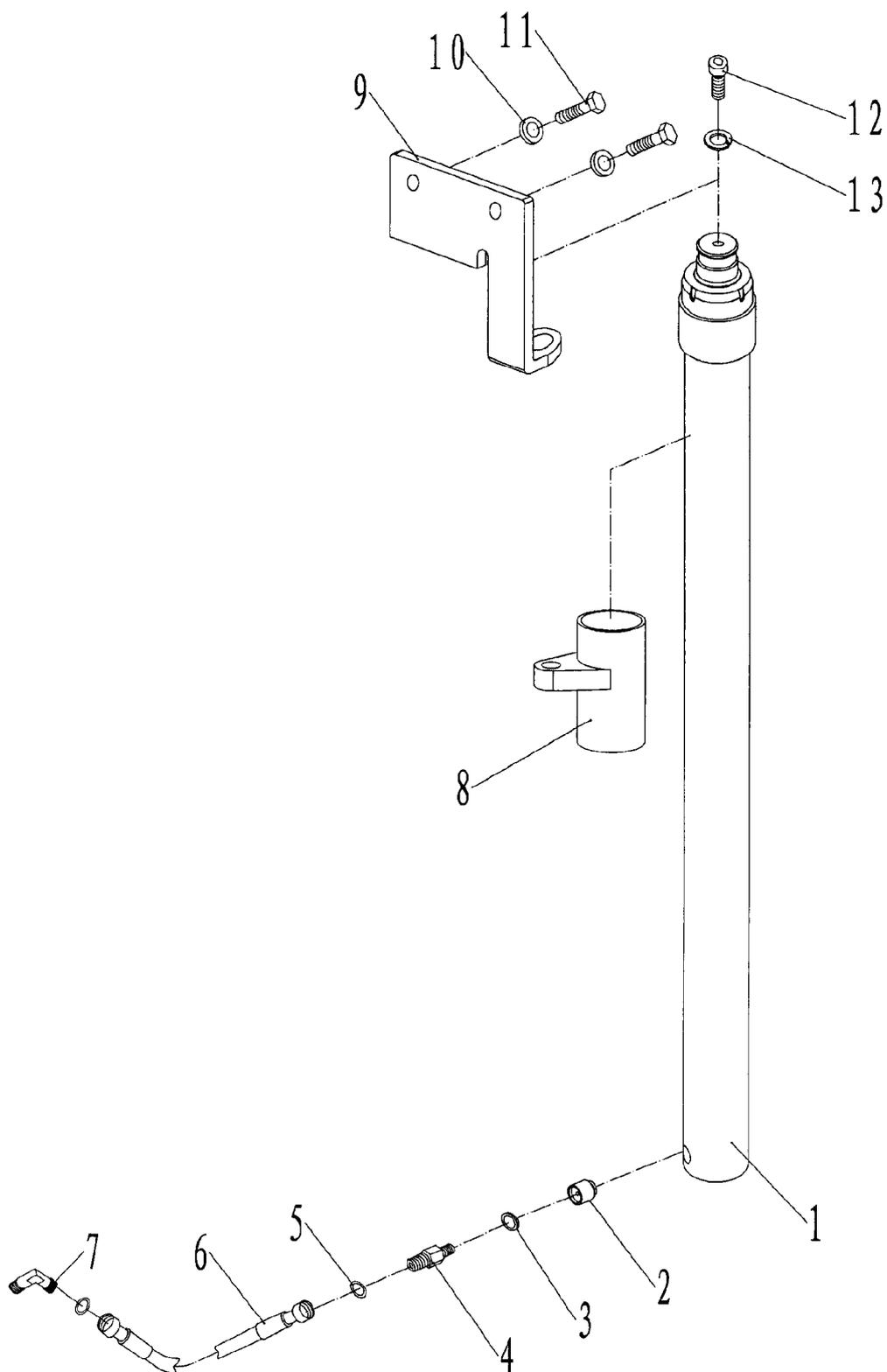
Abbildung 10 Expl. Äußerer Hydraulikzylinder
