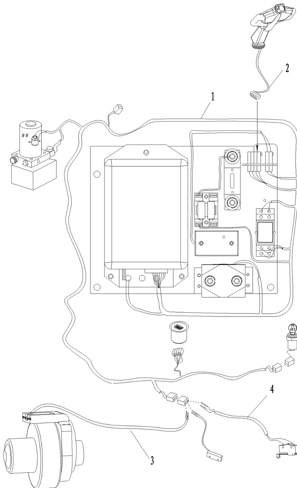
Abbildung 8 Expl. Kabel Deichselsteuerung
