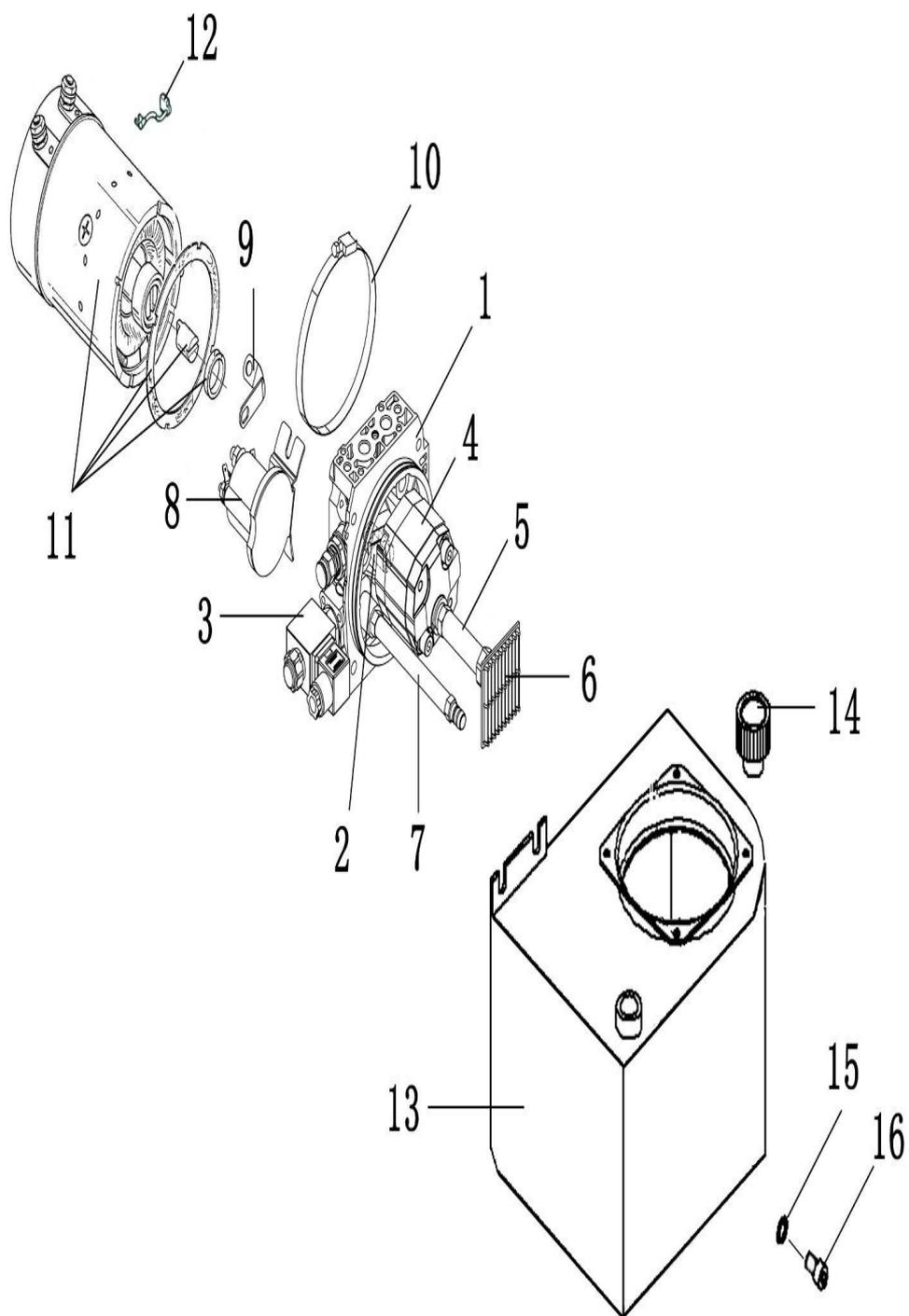
Abbildung 12 Expl. Hydraulikpumpe
