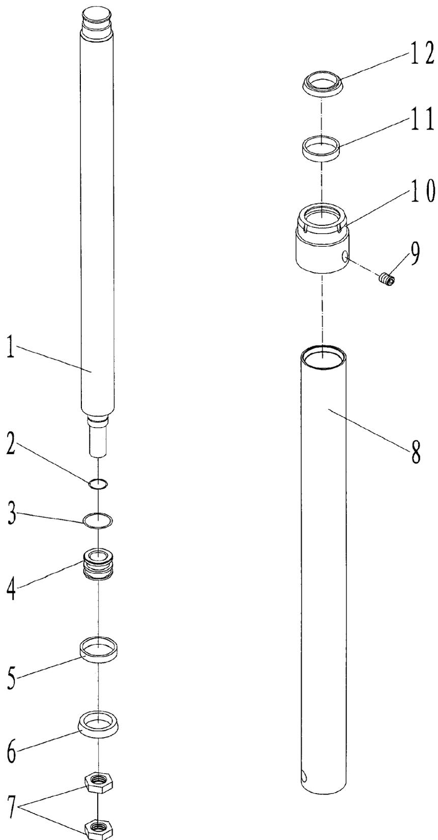
Abbildung 11 Expl. Innerer Hydraulikzylinder
