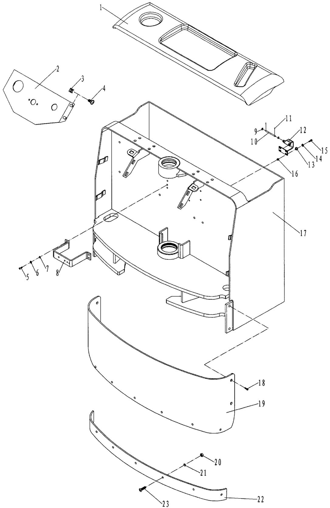
Abbildung 2 Expl. Batteriebox
