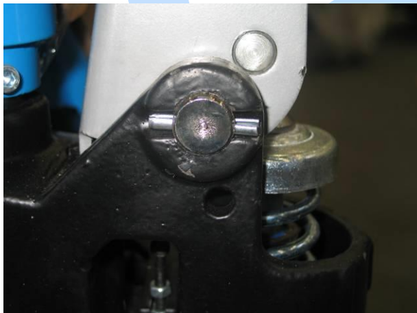
Deichselbolzenposition parallel zum Boden Artikelnummer: GE0000455
