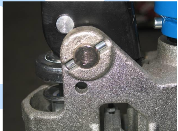
Deichselbolzenposition 45° Winkel zum Boden Artikelnummer: 010102-N105A
