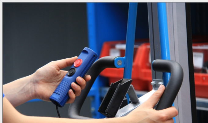
Die Handgriffe sind gummiert und die abnehmbare Steuereinheit mit einer ca. 1,5m langen Zuleitung versehen.
